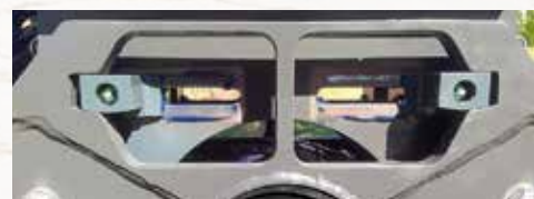
Arretierungskeile verriegelt: Löffelbetrieb – Kraftschlüssige Aufnahme des Verdichterlöffels.
