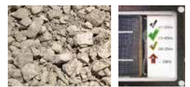
Gemischtkörnige Böden Mittlere Frequenz ca. 35-45 Hz UNIVERSALFREQUENZ
