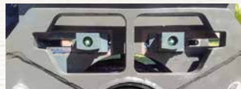
Arretierungskeile entriegelt: Verdichtungsbetrieb – Vibrationsaufnahme über Schwingungsdämpfer.
