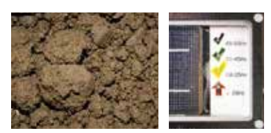
Bindige Böden (Tone, Schluffe) Niedrige Frequenz ca. 28-35 Hz
