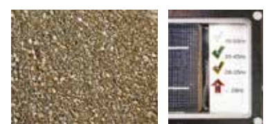
Nichtbindige Böden (Sand, Kiese) Hohe Frequenz ca. 45-55 Hz
