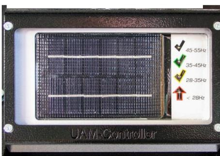
Um Beschädigungen an Rohren und umliegenden Gebäuden zu vermeiden, haben wir den **UAM-Controller** entwickelt. Er misst permanent die Frequenz und warnt den Maschinisten bei gefährlicher Nähe oder Erreichen der Eigenfrequenz des Bodens, z.B. bei feuchten und schweren Böden oder zu großer Auflast auf den Verdichter. Bei Arbeiten im Eigenfrequenzbereich können Schäden an umliegenden Gebäuden oder eingebauten Rohren entstehen.
